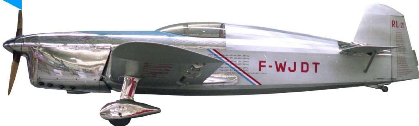
Après avoir construit le monoplace léger RL-12 (1939), le RL-16 de records d'altitude (1949) puis conçu le biplace de tourisme RL-19, René Leduc dessina l'avion RL-20 de records de vitesse. Faute de moyens, il simplifia l'avion pour aboutir au RL-21 équipé d'un moteur Régnier 4-L-00 de 135 ch.
